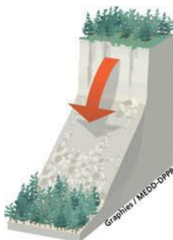
Chute de blocs
